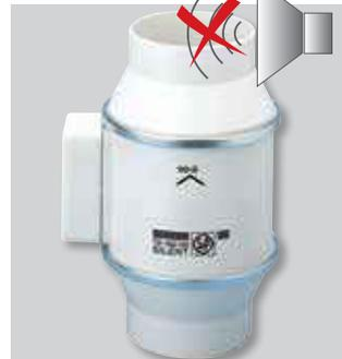
У модели TD-160/100N SILENT электродвигатель крепится к корпусу при помощи резиновых "сайлент-блоков", которые предотвращают передачу вибрации на корпус вентилятора.
