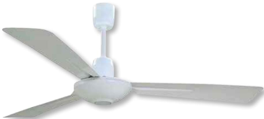
Вентилятор НТВ-150 N IP55 разработан специально для работы в сложных условиях, устойчив к коррозии, защищен от попадания пыли и струй воды со всех сторон. Электродвигатели имеют класс защиты IP55, класс изоляции В и встроенную термозащиту.
