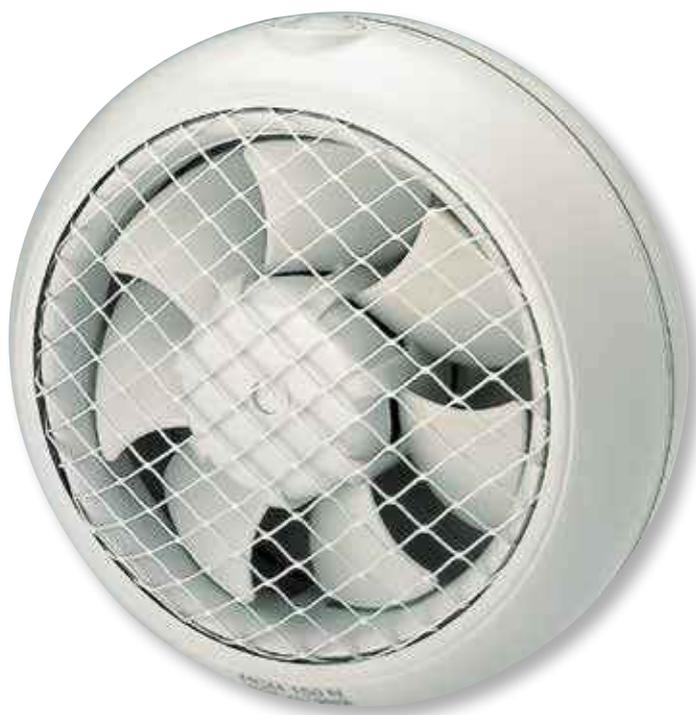
Вытяжные вентиляторы серии HSM-N предназначены для настенной или оконной установки, с непосредственным выбросом воздуха без системы воздуховодов. Корпус и крыльчатка вентилятора изготовлены из пластика. Вентиляторы укомплектованы однофазными электродвигателями (230 В - 50 Гц), класс защиты IPX4, класс изоляции В, плавким предохранителем и инерционными жалюзи.
