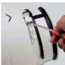
При помощи отвертки, ослабьте защелку.
