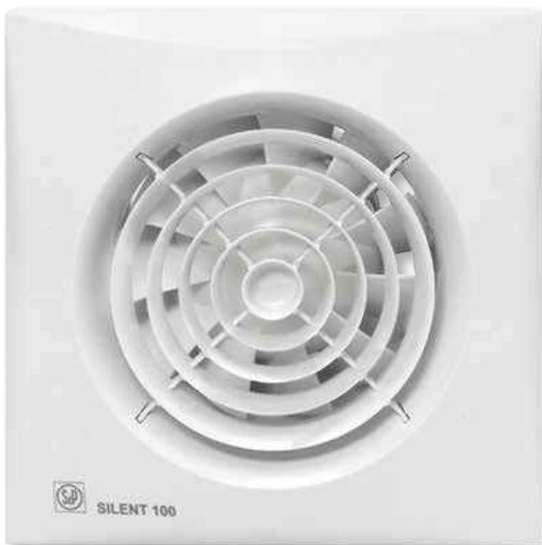
Вентиляторы SILENT-100 изготавливаются из высококачественного пластика, комплектуются обратными клапанами и однофазными электродвигателями (230В-50Гц), класс изоляции В, со встроенной термозащитой. Электродвигатель крепится к корпусу при помощи резиновых "сайлент-блоков", которые предотвращают передачу вибраций на корпус вентилятора.
