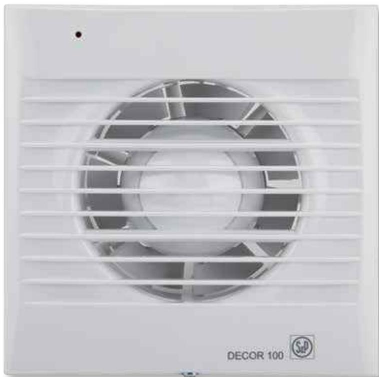
Вентиляторы DECOR-100 изготавливаются из высококачественного пластика, комплектуются световым индикатором работы и однофазным электродвигателем (230В-50Гц), класс изоляции В, со встроенной термозащитой. Модель "Z" оснащается электродвигателями с повышенным сроком службы, укомплектованными шариковыми подшипниками. Вентиляторы имеют II класс герметичности, класс защиты IP 44 и рабочую температуру воздуха от 0°C до +40°C.
