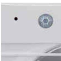
Модель оснащена инфракрасным датчиком движения и регулируемым таймером (1-30 мин.). Вентилятор включается автоматически, когда датчик фиксирует движение в радиусе 4 метров от вентилятора и выключается по прошествии времени, заданного на таймере.
