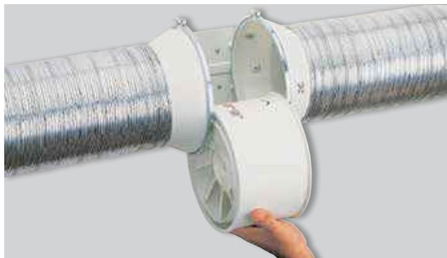
Уникальная конструкция вентилятора позволяет извлекать блок двигатель-крыльчатка без демонтажа воздуховодов, что делает обслуживание вентилятора легким и быстрым.
