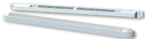
Саморегулирующиеся приточные клапаны с расходом воздуха 22, 30 и 45 м³/ч изготавливаются из литого полистирола белого или коричневого цвета. Приточные клапаны предназначены для установки на оконных рамах.
