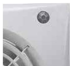
Модель оснащена инфракрасным датчиком движения и регулируемым таймером (1-30 мин.). Вентилятор включается автоматически, когда датчик фиксирует движение в радиусе 4 метров от вентилятора и выключается по прошествии времени, заданного на таймере.
